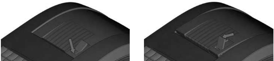
Obrázek 2.6 – Zavedení papírové pásky do tiskárny
